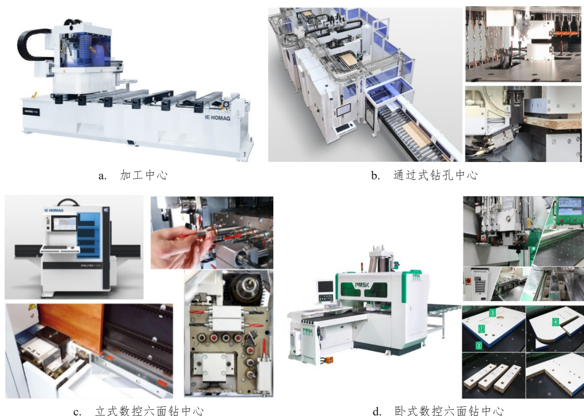
图 7 钻孔设备 Fig.7 Drilling machines
